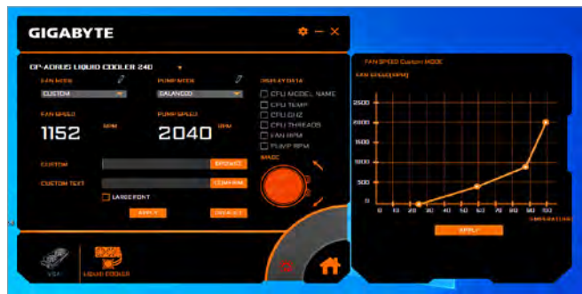
Gigabytes interne Lüfter-/Pumpensteuerung ist vorbildlich, RGB- und Display-Steuerung erfordern aber ein zweites, noch ausbaufähiges Tool.
