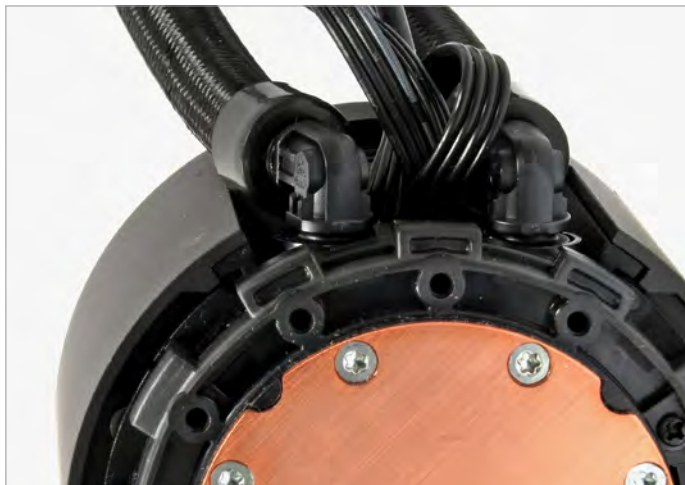
Ungünstig: Die Verkleidung von Gigabytes Pumpe verhindert, dass die Schläuche der Aorus Liquid Cooler 240 frei zur Seite gedreht werden können.
