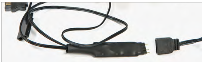
Keine Software, wenig Funktionen, kein Schalter: Silentium PCs Nano-Reset-Controller will über den zweckentfremdeten Gehäuse-Reset-Switch bedient werden.
