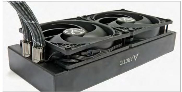
Die Halterung der Liquid Freezer II erinnert an den Arctic Freezer 34, lässt sich aber problemlos auf Sockel 1151 nutzen. Lobenswert: Der Spannungswandlerlüfter lässt sich abklebmen, seine Radiatorkollegen sind samt Kabelmanagement vormontiert.
