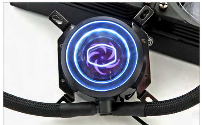
Unhörbar (gedrosselt aus 20 cm Entfernung) beziehungsweise extrem leise (Normalbetrieb), aber nicht unsichtbar: Die Pumpe der Cooler Master ML240P Mirage
