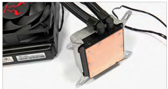
Die Pumpeneinheit der Rotoro Bifrost zeigt wenig Kunststoff; Aluminium steigert die Haltbarkeit aber nicht unbedingt und die Kühlleistung offensichtlich auch nicht.
